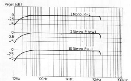
N) Frequenzgang FM Mono/Stereo (von Antenneneingang bis Lautsprecher Ausgang), Meßspannung 2 mV/100 MHz
